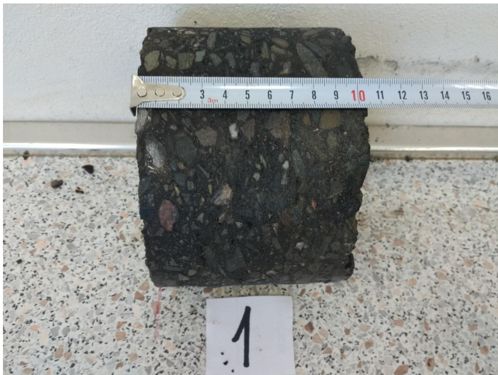
Obr. 25 AC vývrt JV7, most 644-002 Pěčíkov
